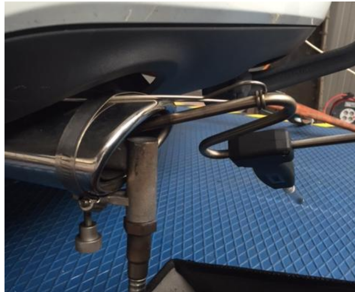
Abbildung 1: Auspuffrohr mit Messsonde und Breitbandlambdasonde
