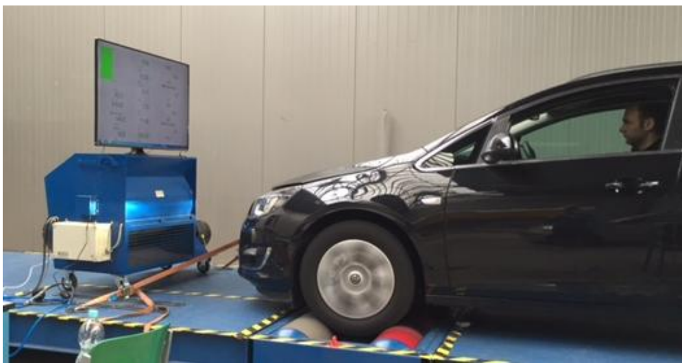
Abbildung 3: Messfahrt auf dem Rollenprüfstand
