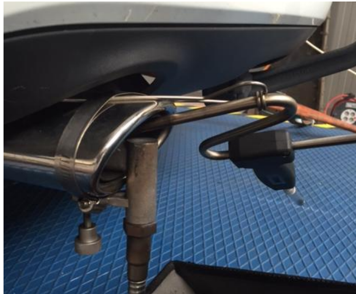
Abbildung 1: Auspuffrohr mit Messsonde und Breitbandlambdasonde
